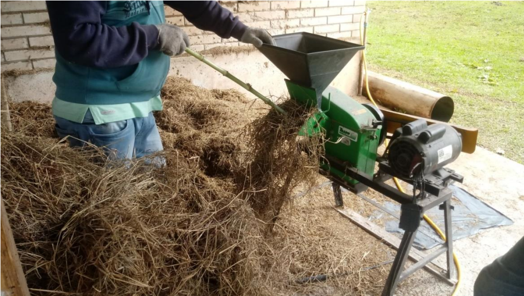
Figura 7 – Feno sendo triturado em porções menores para não furar o saco de substrato.
